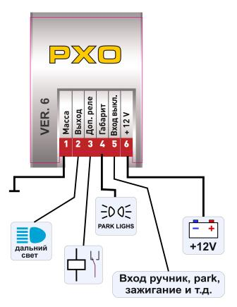
Схема подключения универсальна, однако в зависимости от автомобиля может отличаться. Если используется РХО+, то силовой выход (+). При использовании РХО (-), силовой выход соответственно минус. Обращайте внимание на то, каким сигналом у вас управляются лампы дальнего света, и в зависимости от этого выбирайте РХО.
