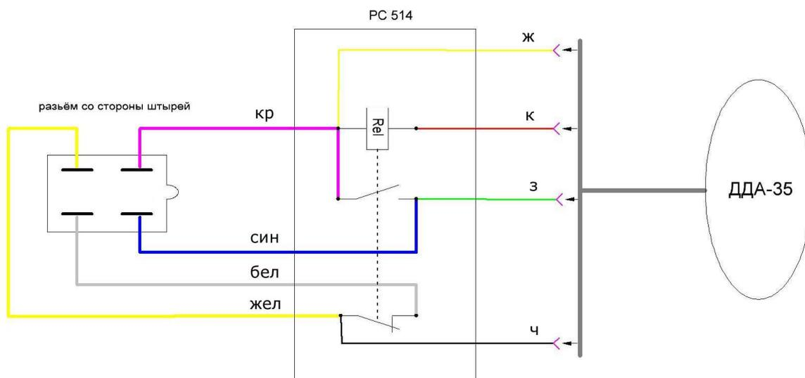
Датчик включен в положении «прерывистый режим» подрулевого переключателя.
